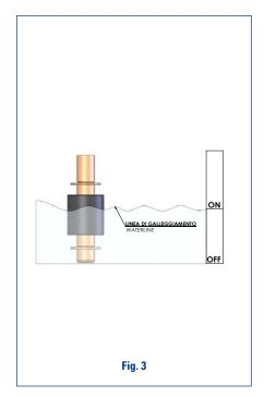
I sensori di livello elettromagnetici sfruttano la forza del magnete contenuto nel galleggiante per cambiare la condizione elettrica di un contatto reed.
