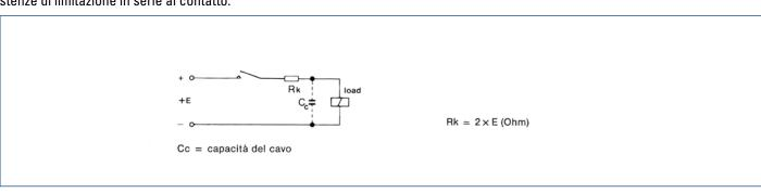
**NB:** sono trascurabili gli effetti dovuti a cavi con lunghezza minore di 10 metri the effects due to cables of less than 10 meters are insignificant
